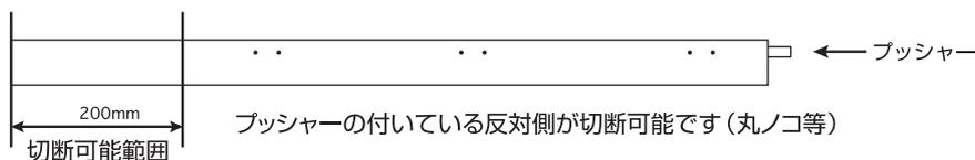
《注意》 内枠レール(アルミ)の切断面は外枠(アルミ)に対して必ず2mm程度短く切断してください。
